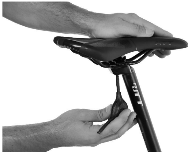
15. Poner el sillín en la tija y colocarlo a 0°. Después atornillar.
