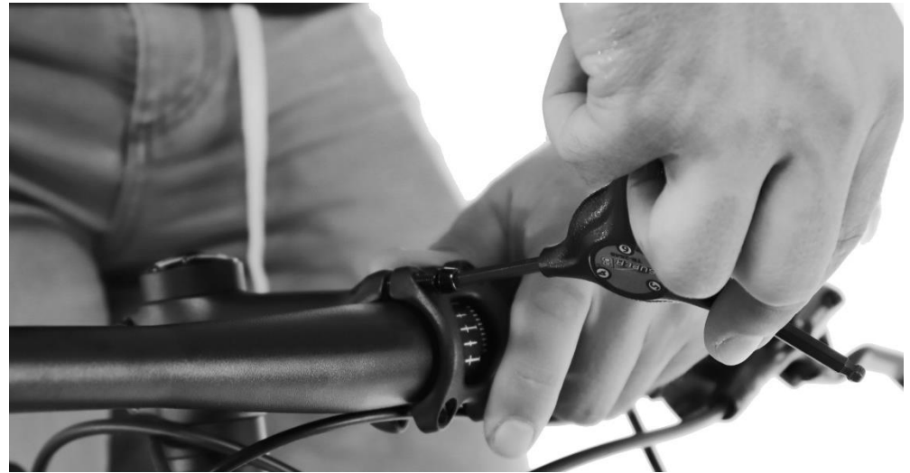
6. Poner el manillar y atornillar la tapa con sus 4 tornillos.
