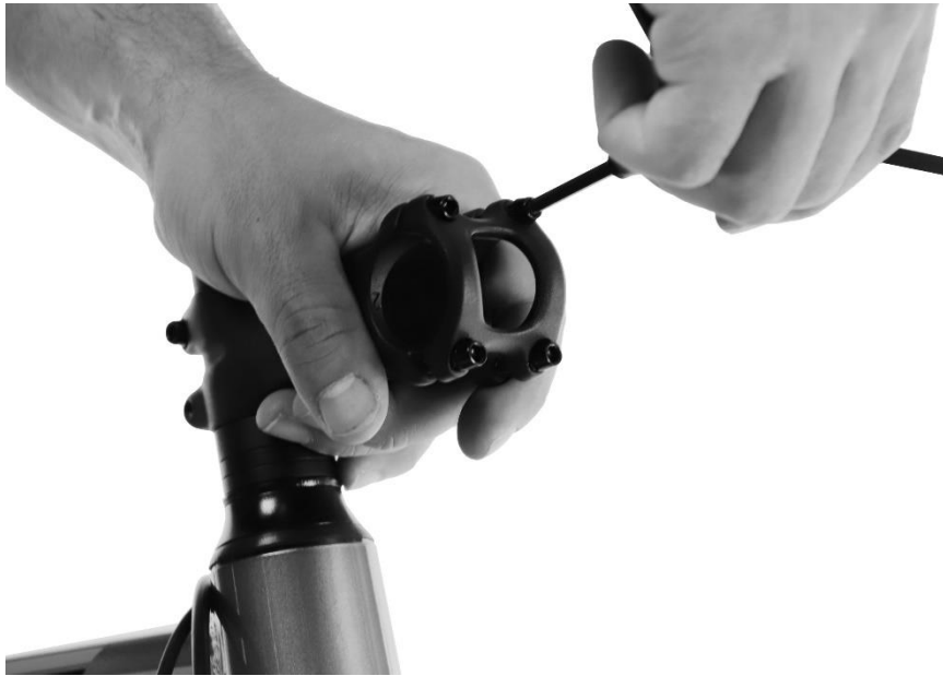
5. Sacar la tapa de la potencia y sus 4 tornillos.
