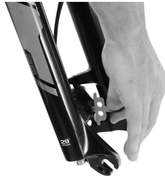
12. Extraer la protección del freno delantero.
