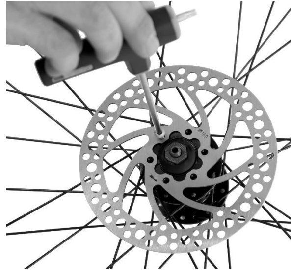
10. Poner el disco y sus tornillos. Asegurarse que la dirección del disco y de la rueda coincidan.
