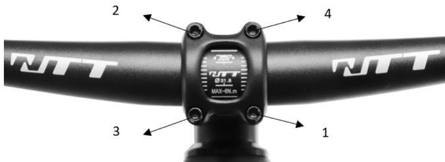
7. Asegurarse que el manillar queda centrado usando las líneas de referencia. Apretar los tornillos con el orden de la imagen.
