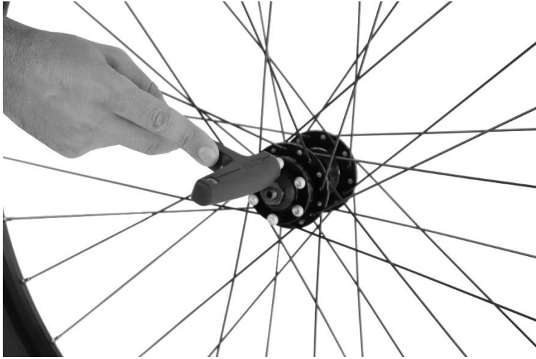
9. Sacar los 6 tornillos del buje.
