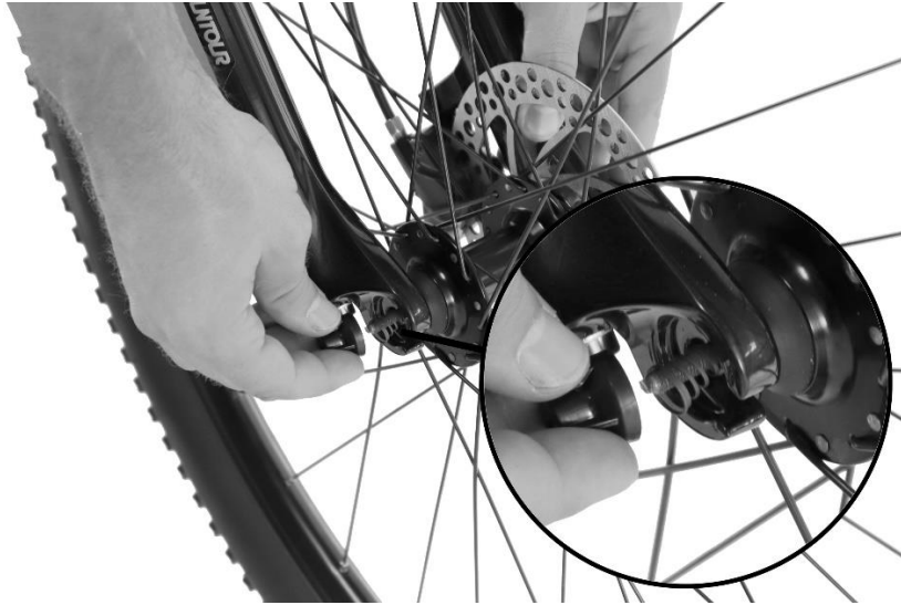
13. Poner la rueda delantera en la horquilla. Si el eje trae muelles, ponerlos como se indica en la imagen. Atornillar el eje y cerrar la palanca.
