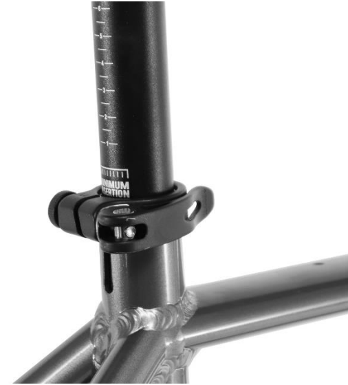
14. Abrir el cierre de sillín e insertar la tija. Asegurarse que queda la marca de mínima inserción dentro del tubo. Apretar el tornillo y luego cerrar la palanca.
