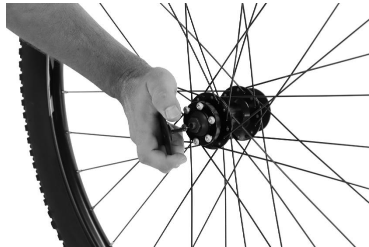
8. Extraer las protecciones del eje de la rueda.
